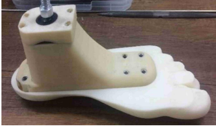
Şekil 15. Ayak ve bilek kısımlarının montajlı hali
